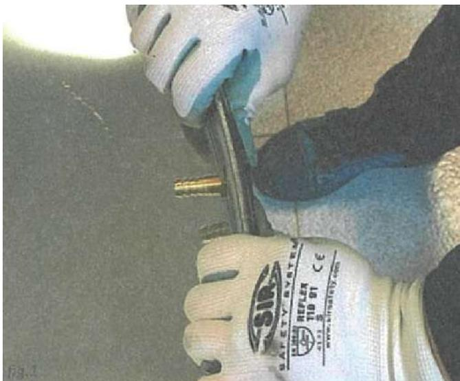
**Opérateur 1** : Insérer la buse de la chambre à air dans le trou sur le bord du flotteur et tenir fermement avec les deux mains la chambre à air à proximité de la buse
