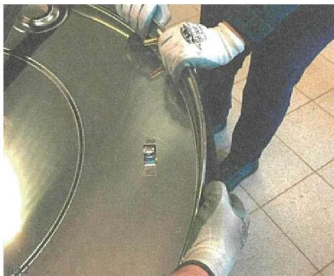
**Opérateur 2** : Faire pression sur la chambre à air et la tirer de manière à l'insérer dans son siège sur le bord extérieur du flotteur.
