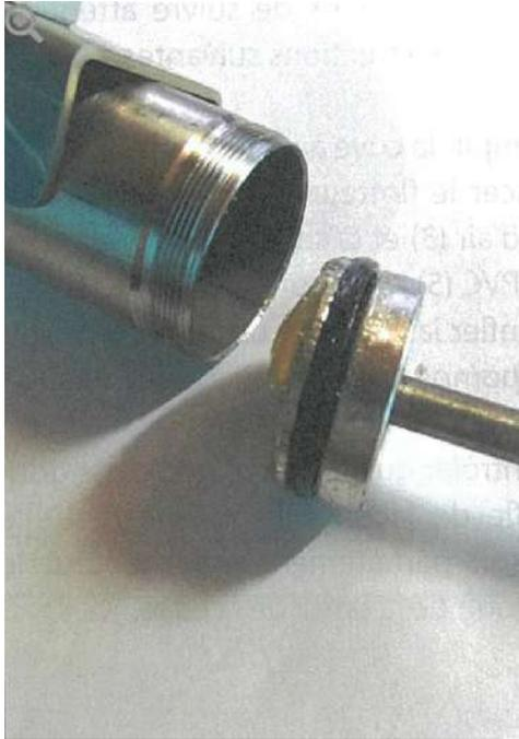
**Les joints toriques ou les joints de pompe** doivent être nettoyés ou graissés avec de l'huile alimentaire ou de la graisse de vaseline tous les 6 mois.
